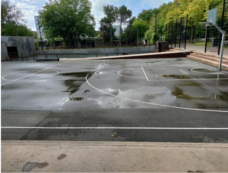
Kuva 17. Esimerkki kaupunkiympäristön monikäyttöisyydestä: kuivalla säällä alue toimii urheilukenttänä ja harvinaisella rankkasateella alue muuttuu tulvavesien keräysaltaaksi (AFRY Finland Oy)
